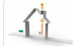
Système C+ EVO II Amenée naturelle et évacuation à la demande
