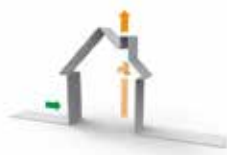
Système C Amenée naturelle et évacuation mécanique
